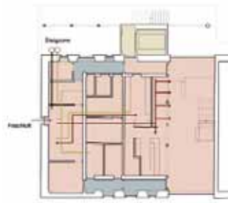
Dämmperimeter, Lüftung EG 1:250
